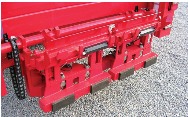
Vejesystem med 2 stk. 300 kg units indbygget i baglift og kombineret med RFID registreringssystem
